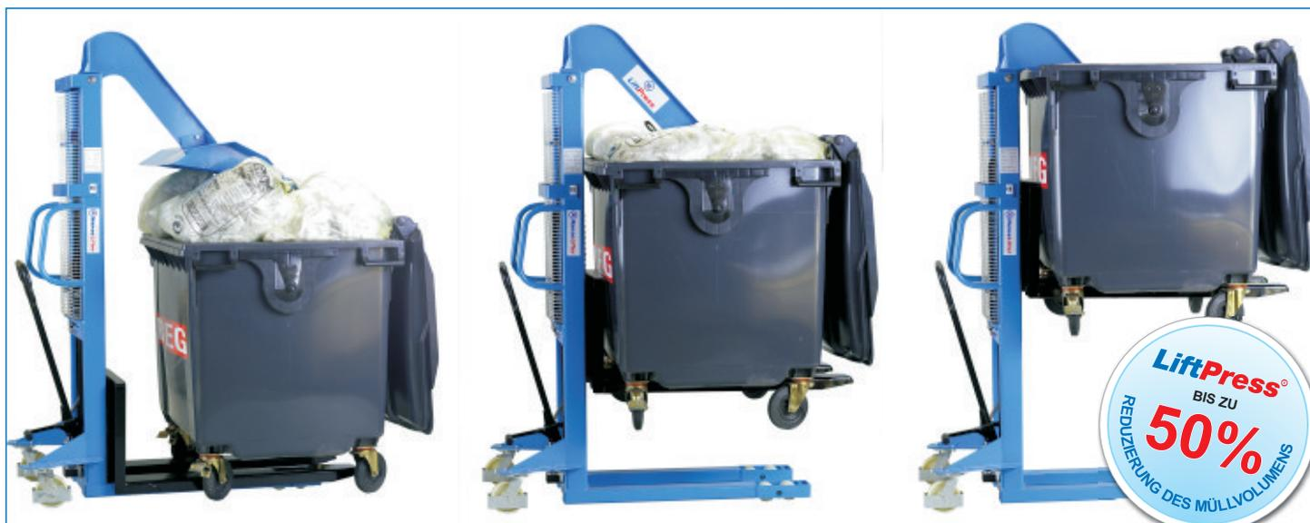
Mit dem innovativen LiftPress-Pressaufsatz bauen Sie Ihren Hochhubwagen SDJ1016 in eine Müllpresse um.
