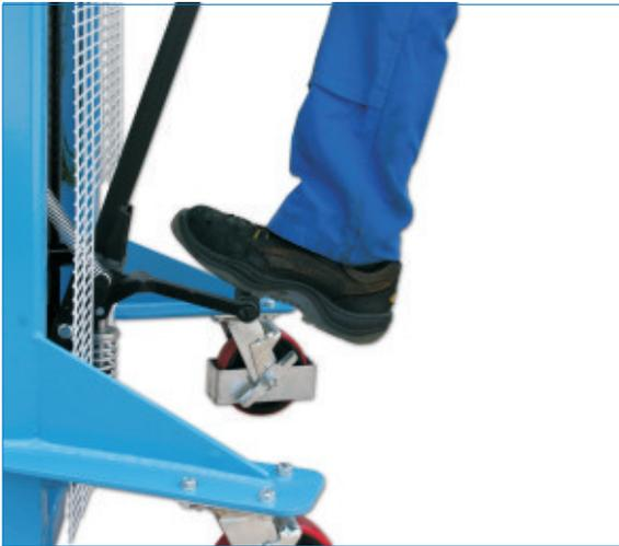
Die SDJ-Modelle lassen sich einfach und bequem per Fußpedal betätigen.
