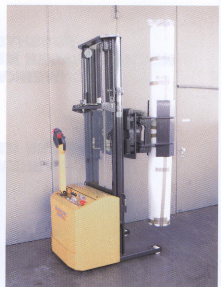
Sonderlösung mit elektrischem Fahrentrieb für Stahlzylinder
