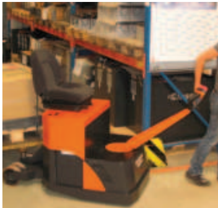
Verwendung als Gehgerät usable as pedestrain-tractor
