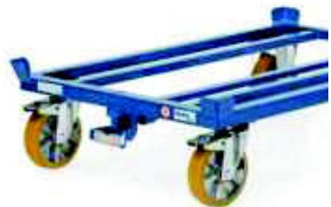
Selbstsichernde Deichsel aus Flachstahl an der Bockrollenseite. Deichselauge Ø 26,5 mm. Bequeme Fußbedienung. Selbstaufstellend mittels Gasdruckfeder.
